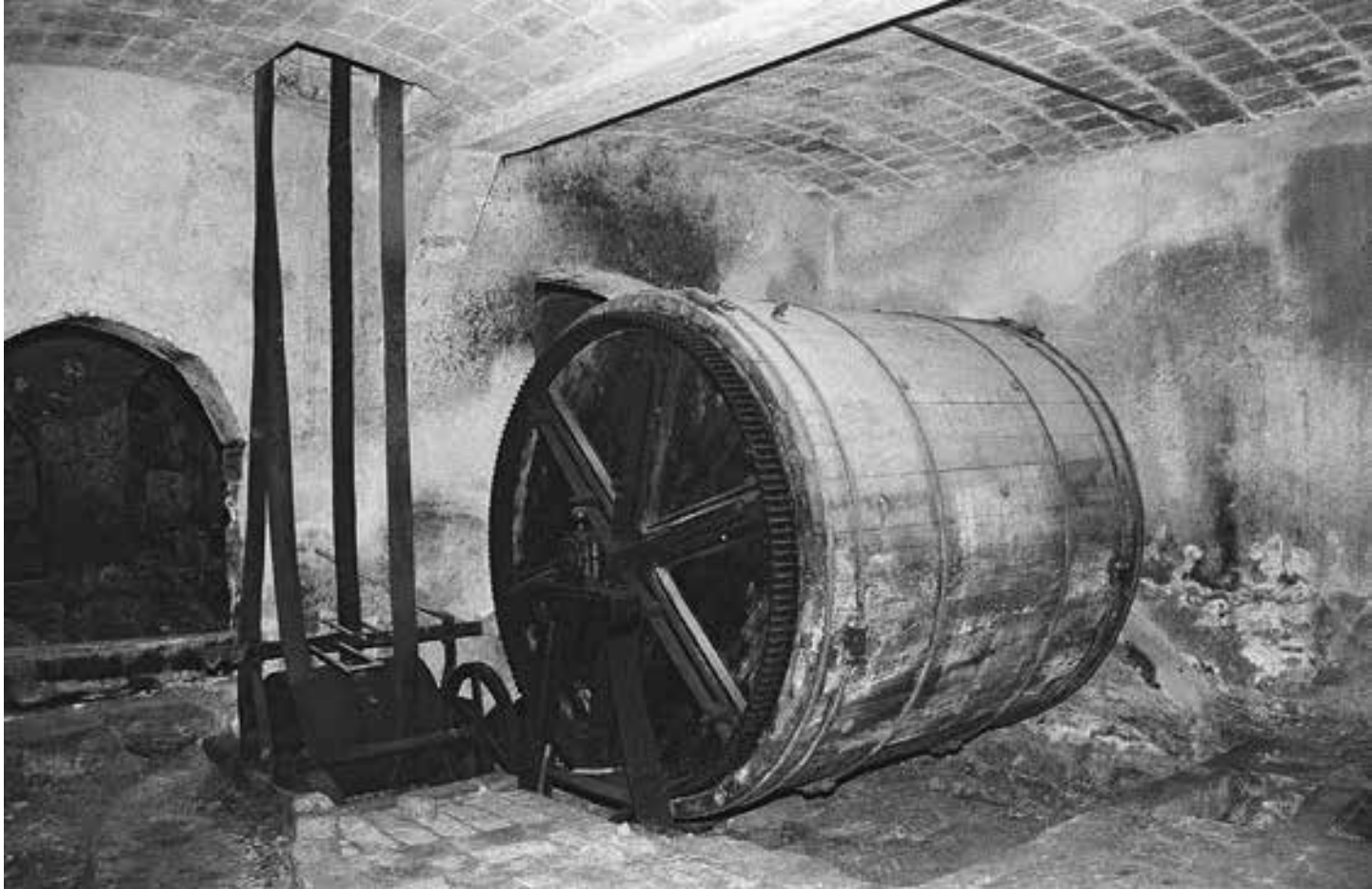
Un dels bombos utilitzats en l'adob de pells (CECI, Conxa Castells)
